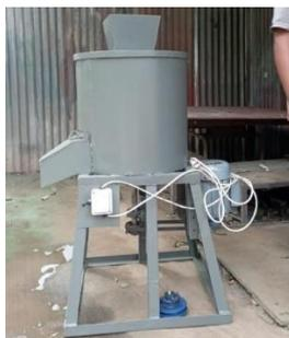
Gambar 1. Pembuatan Akhir Mesin Pencacah daun[5]
