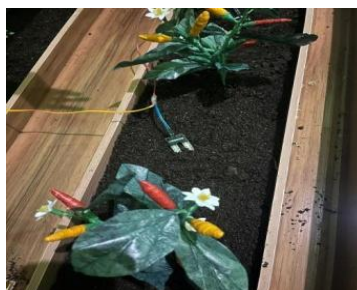
Gambar 3. Pengujian Sensor YL-69 Mendeteksi Kelembaban Tanah
