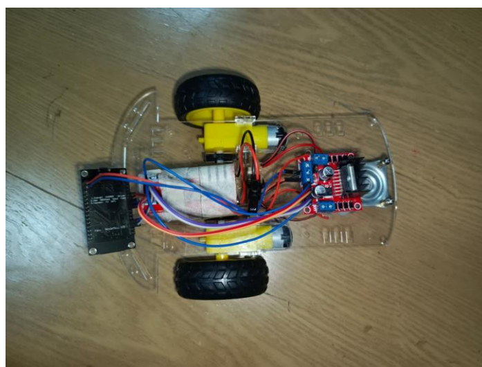
Gambar 1. Hasil Perakitan Robot Mobil Berbasis ESP8266
