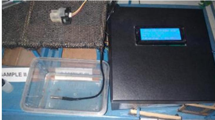
Gambar 6. Pengujian Sensor Suhu
