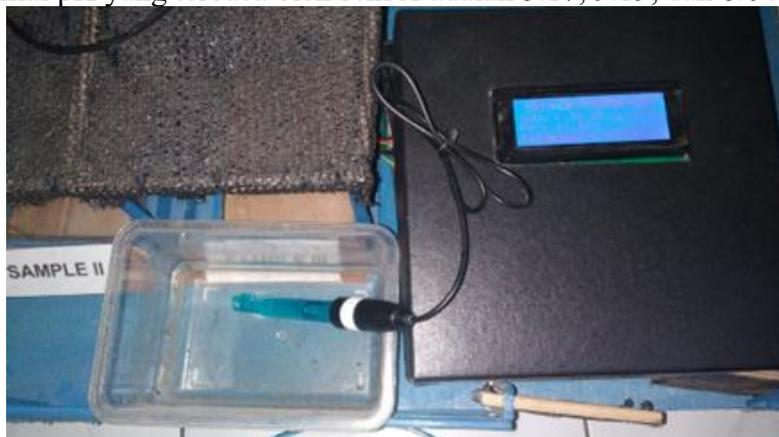
Gambar 7. Pengujian Sensor pH
